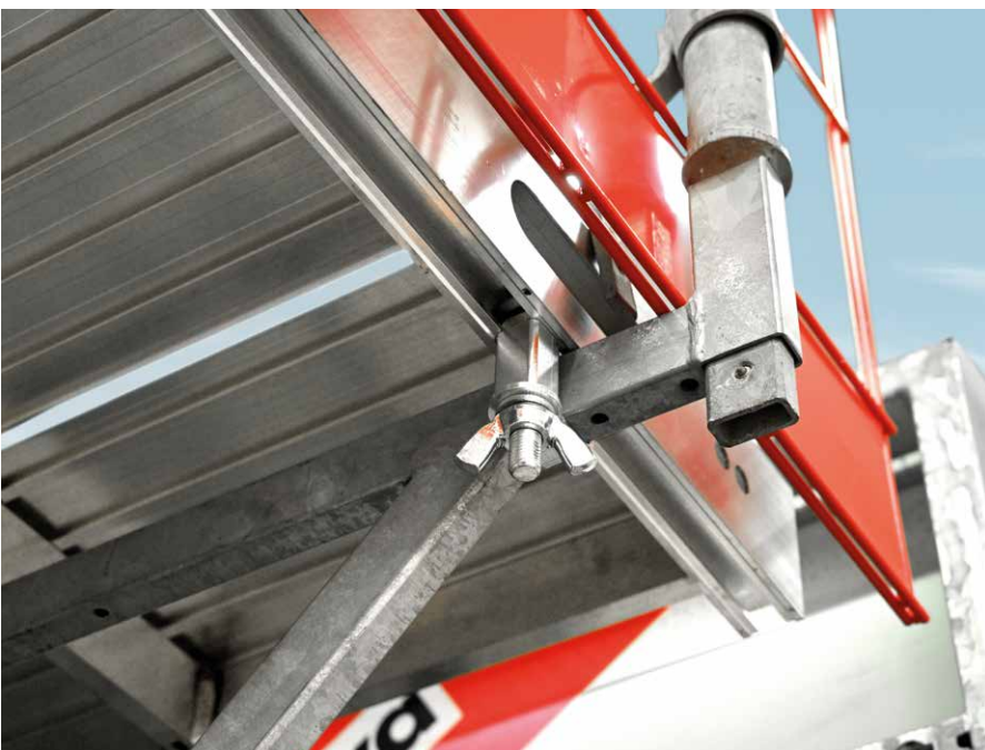
La plate-forme Alu est mise en place à l'aide de la console passerelle 90 ; elle peut être équipée en un tournemain du potelet de garde-corps 48/120 UK et du garde-corps arrière MEVA.
