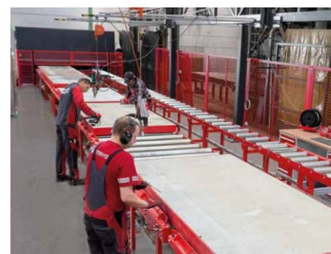
Die neue vollautomatische Reinigungsstraße reduziert den Ressourcenverbrauch und erhöht die Materialverfügbarkeit. Reparaturen finden unter optimalen Arbeitsbedingungen am neuen Rollengang statt.
