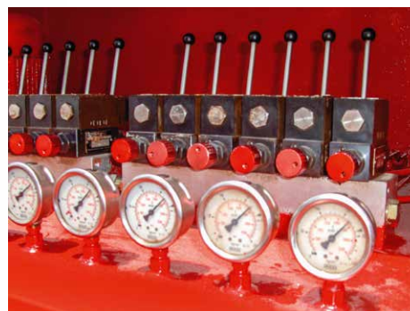
Die eingehauste, hydraulische Kletterautomatik ist einfach und schnell mit kleinen Teams zu bedienen.
