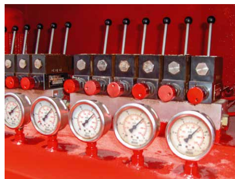
Die eingehauste, hydraulische Kletterautomatik ist einfach und schnell mit kleinen Teams zu bedienen.
