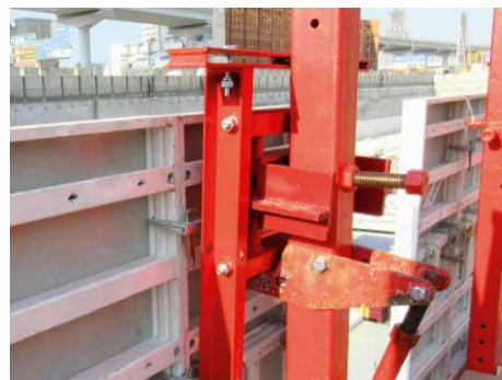
Die 3-Wege-Justierung bietet höchste Präzision. Dabei kann die hängende Schalung von Hand in drei Richtungen bewegt und justiert werden und lässt sich somit schnell und einfach an die Bauwerksgeometrie anpassen.
